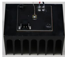
照片 6 让鳍片向下设置 (妨碍空气流动的朝向)
